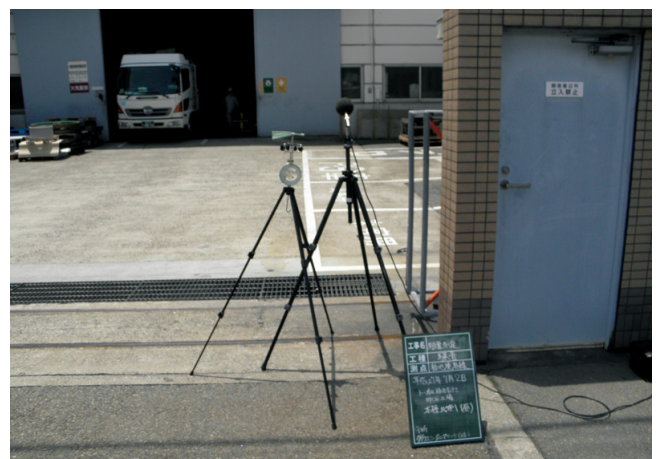
専用機器を使った騒音測定
