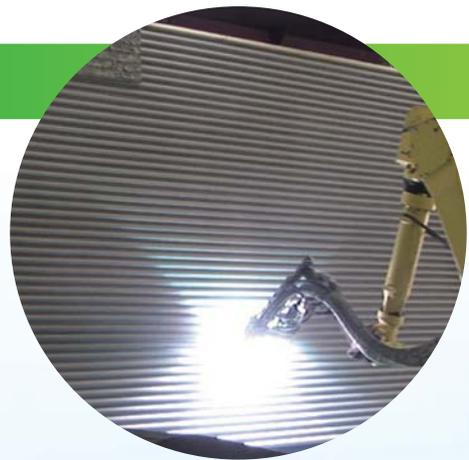
されるボイラ伝熱管への耐高温腐食皮膜や、排煙から硫酸化物を取り除く排煙脱硫装置部品への耐摩耗皮膜を溶射により形成することで、これら部材の長寿命化に貢献しています。
